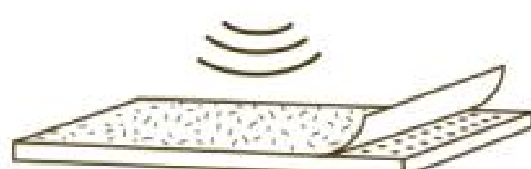
Panneau acoustique MDF perforé + décor sur flax Acoustic panel Perforated MDF + decor on flax
